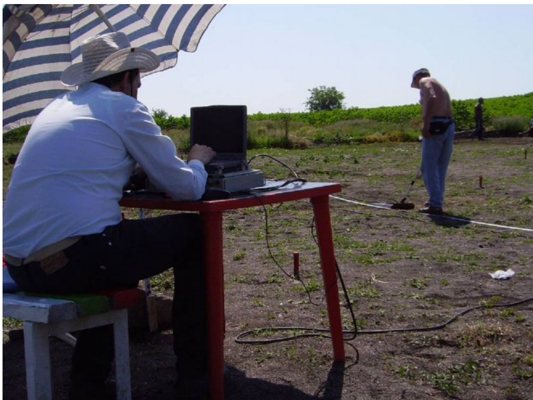
Фиг. 2. Сканиране на профили от един полигон на неолитен археологически обект до с. Ябълково с георадар от екип на лабораторията по археогеофизика.
