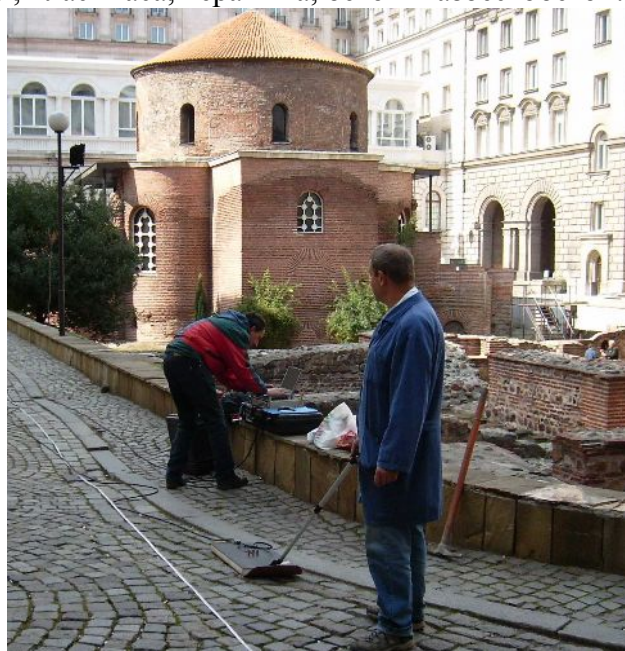
Фиг. 3. Сканиране на градски терен с георадар за търсене на канализационни тръби от екип на лабораторията по археогеофизика
